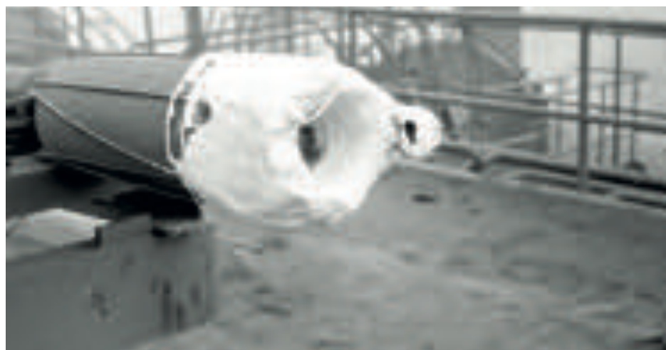
Een lans met een ééngats-lans, eind zestiger jaren vervangen door Japanse drie-gats-lansen
